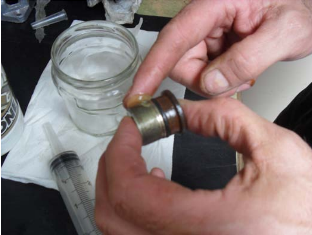
Graisser le filtage du bouchon ainsi que le joint torique.
