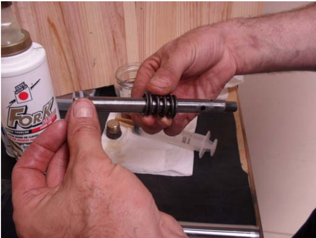
Mise en place du système hydraulique.
